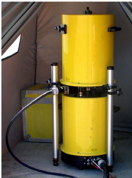
5. ábra. MicroG-LaCoste gyártmányú Micro-g A10-es terepi abszolút graviméter
