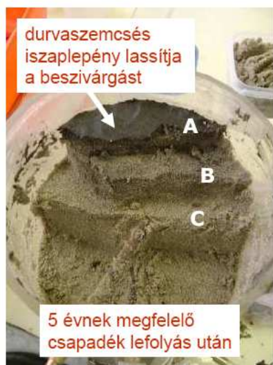
4.14 ábra: Lefolyás szűrése homoktölteten (Budai, 2008)
