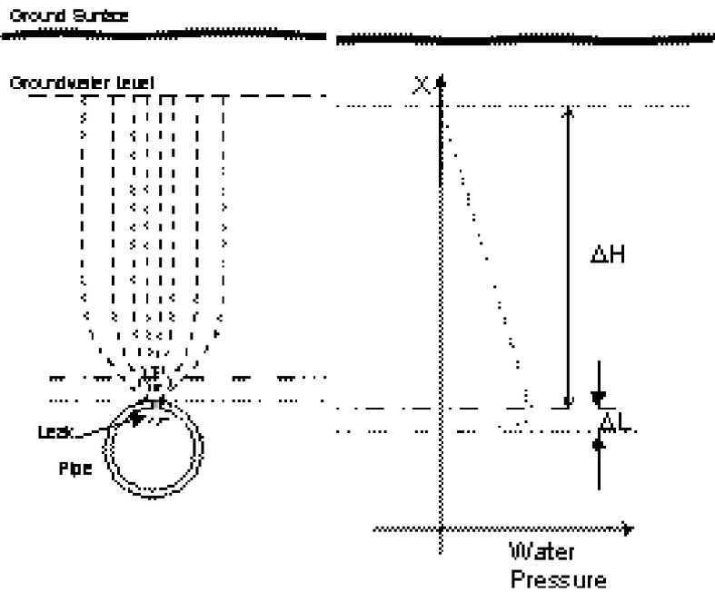
$$Q(\text{infiltration}) = A_{\text{leak}} \cdot \Delta H_{\text{GW}} \cdot (k_f / \Delta L) = 10 \cdot A_{\text{leak}} \cdot \Delta H \cdot k_f$$
